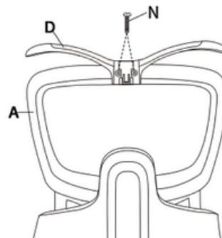
Fixe o suporte (D) à parte de trás (A) com 2 parafusos M6\*25 (N)
